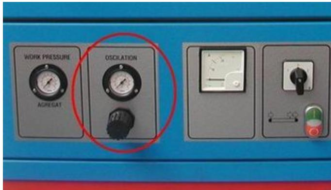
Регулировка давления в пневмоцилиндре осцилляции (max=3bar)
