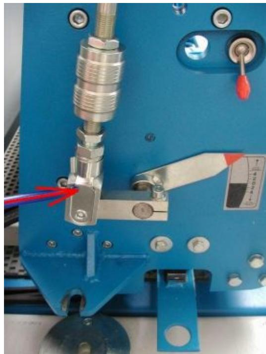
8. Расфиксируйте и отпустите винты удерживающие рычажный механизм опускания шлифовальной планки (утюжка) или вала. Если станок оснащен пневматическим цилиндром подъема опускания, следует отпустить также и винт удерживающий пневмоцилиндр. Затем полностью снимите весь механизм
