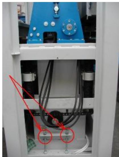
2. Просуньте ремни через зазор между станиной и конвейером таким образом, чтобы они были уложены на рабочем столе
