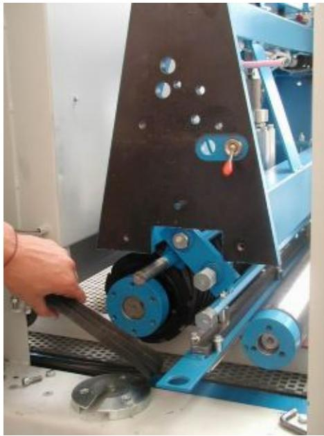
После установки новых ремней на место их следует натянуть до нормального рабочего состояния. Также следует поставить на место предохранительную скобу на штоке пневмоцилиндра натяжения шлифовальной ленты и скобу концевика на двери станка.
