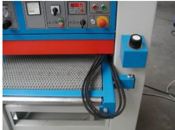
4. Установите два прямоугольных бруска одинаковой высоты на рабочий стол по краям и заведите их под рабочий вал, затем поднимите рабочий стол (до тех пор пока бруски не коснутся вала)
