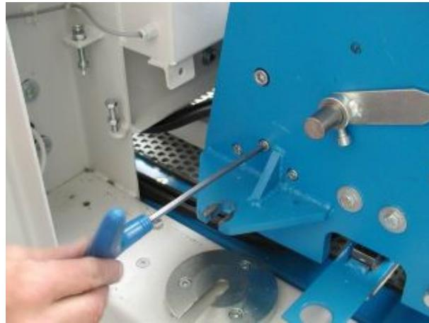
10. Для узла **типа С** также следует расфиксировать опору подшипника натяжного ролика
